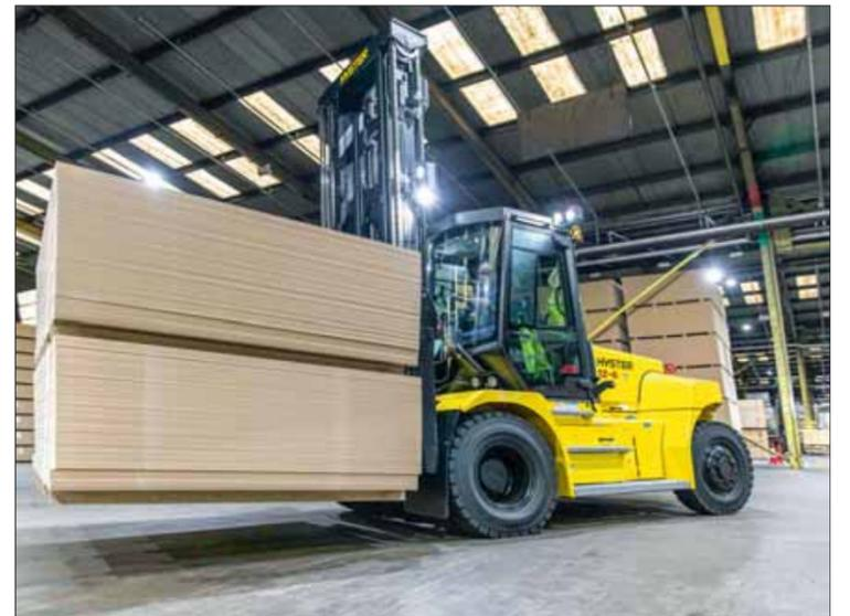
Weitere Verbesserungen an Kabine und Hubmast erleichtern das sichere Handling auch von schweren Lasten auf engem Raum. Fotos: Hyster
