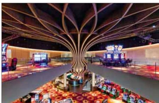
Die freigeformte Tragstruktur des Casinos in Venlo ist aus einfach und doppelt gekrümmten Brettstichholz-Bogenbindern erstellt, die abgerundeten Wände in Holzelementbauweise. Foto: Barwerd van der Plas
