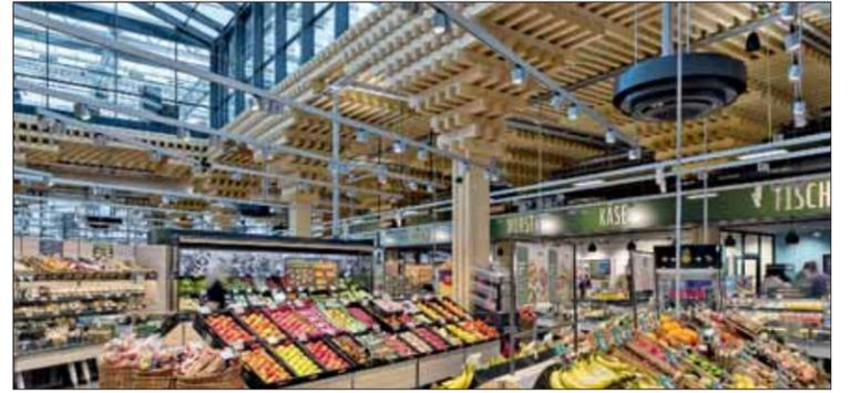
Die Tragwerke der neuen Rewe-Supermarkthallen sind bewusst als Materialspeicher inszeniert, was insbesondere bei den gestaffelten Stützenkapiteln sichtbar wird und die Wiederverwendbarkeit der Bauteile deutlich machen will. Sie schaffen aber auch eine besondere Einkaufsatmosphäre.
